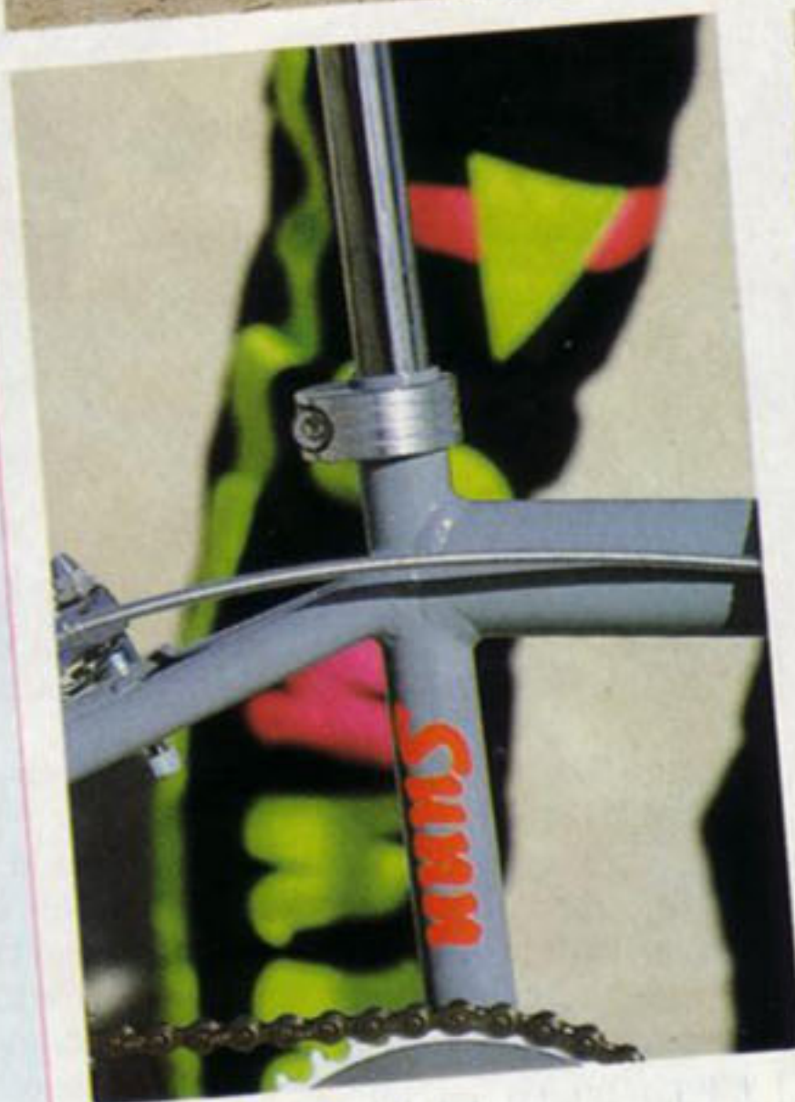
Ci-dessus le Super-class alu 87. Un cadre de 1,490 kg équipé d'un pédalier Peregrine, jantes Araya, frein Dia Compe, tube de selle et collier de selle Sunn, potence Hutch... Kit mousse War Paint signé Garnier. Ci-dessous, les cotes du cadre.
