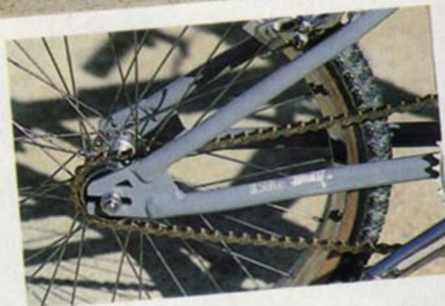
Ci-dessus le Super-class alu 87. Un cadre de 1,490 kg équipé d'un pédalier Peregrine, jantes Araya, frein Dia Compe, tube de selle et collier de selle Sunn, potence Hutch... Kit mousse War Paint signé Garnier. Ci-dessous, les cotes du cadre.
