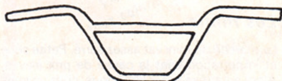
Guidon Woody Itson renforcé au niveau de la potence.
