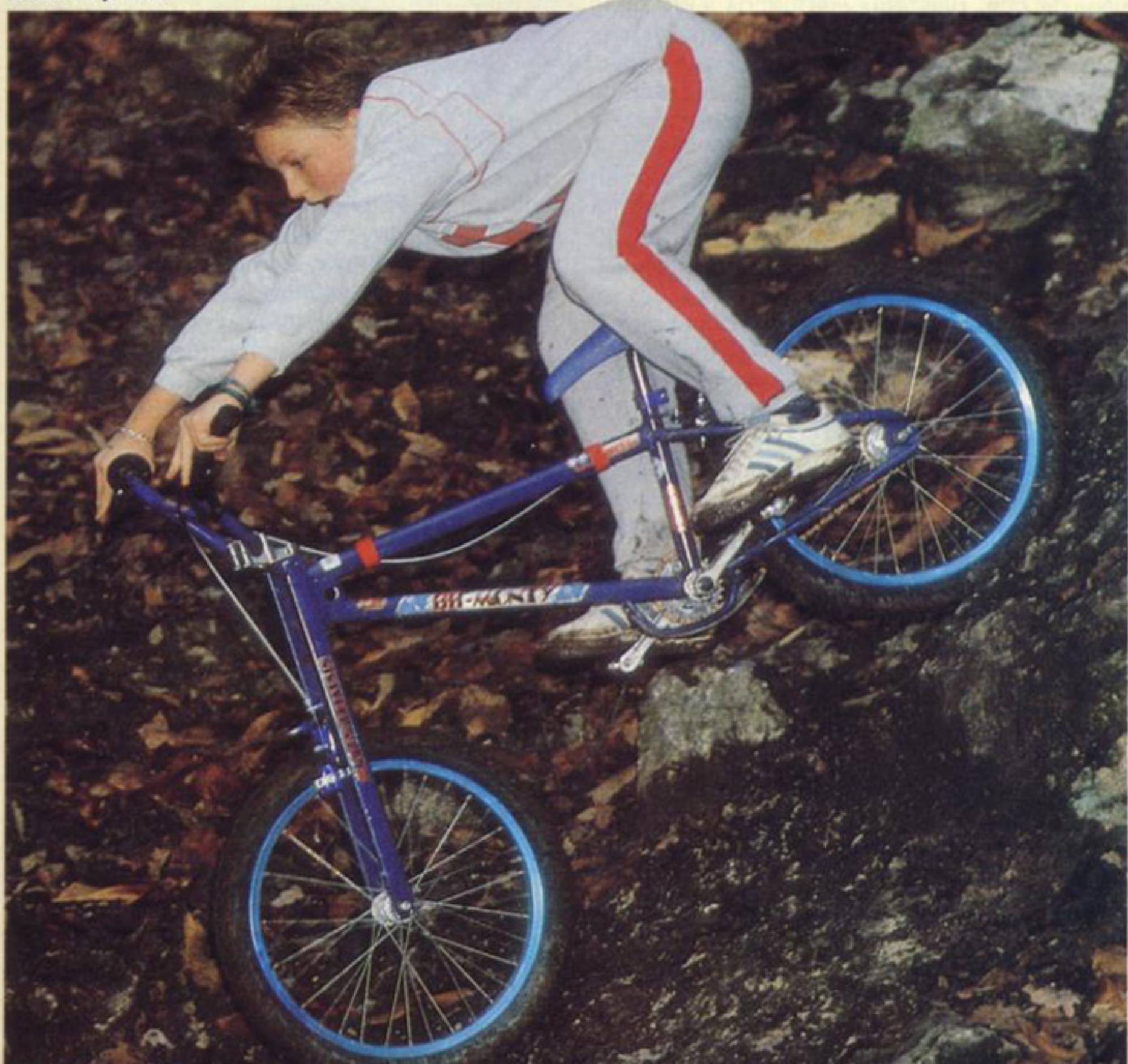
Système un peu archaïque mais efficace de la direction du Monty. Ça tient et c'est léger. Bon compromis.
