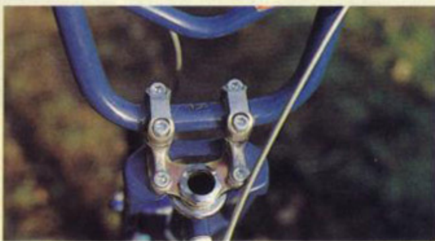
Système un peu archaïque mais efficace de la direction du Monty. Ça tient et c'est léger. Bon compromis.
