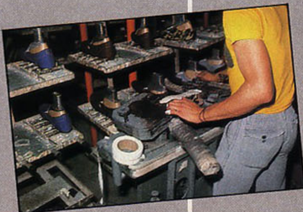
Confection et mise en forme des dessus de chaussures en coton.
