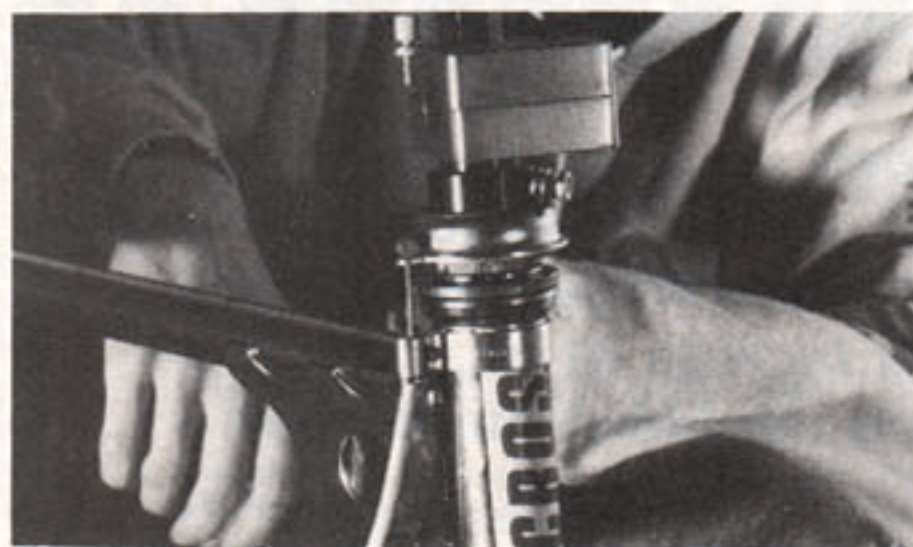
Enfilez votre câble dans la cuvette puis dans le guide du collier.
