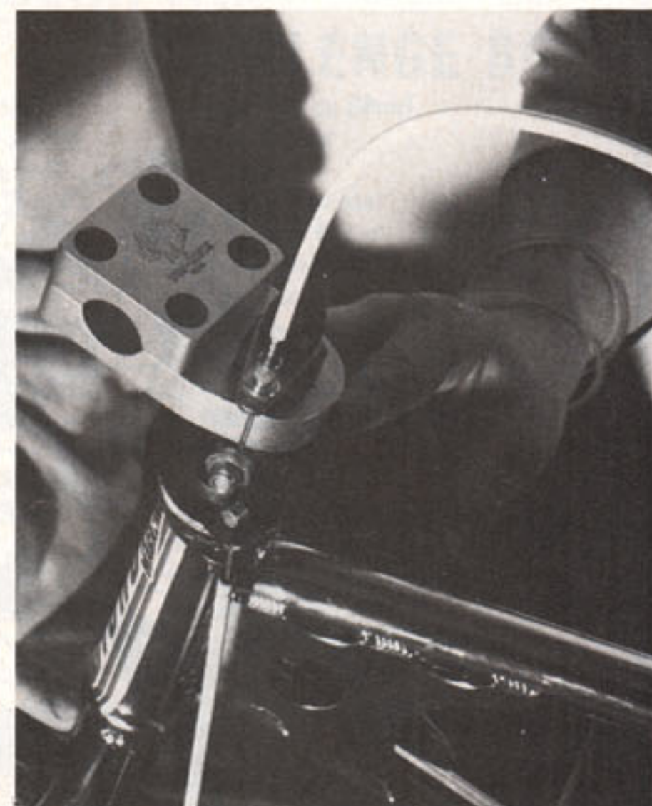
Le câble (n° 4) et son blocage (n° 5) sont maintenant en place. Le câble supérieur est comme pour le Spin Master, enserré sur la cuvette de graphite noir.
