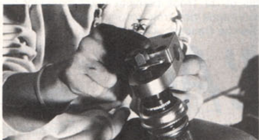
Allons un peu plus vite. Assemblez comme pour le ACS le guide n° 6 dans l'expandeur et la potence. N'oubliez pas les rondelles (n° 6 bis).
