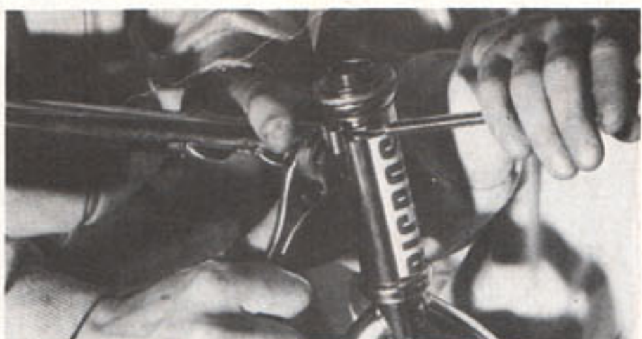
On n'est pas trop de deux. Très franchement, nous n'avons pas réussi. Un tour d'inspection dans la boîte à outils nous a permis de « dégoter » un boulon plus grand. Celui du kit est réellement trop court.
