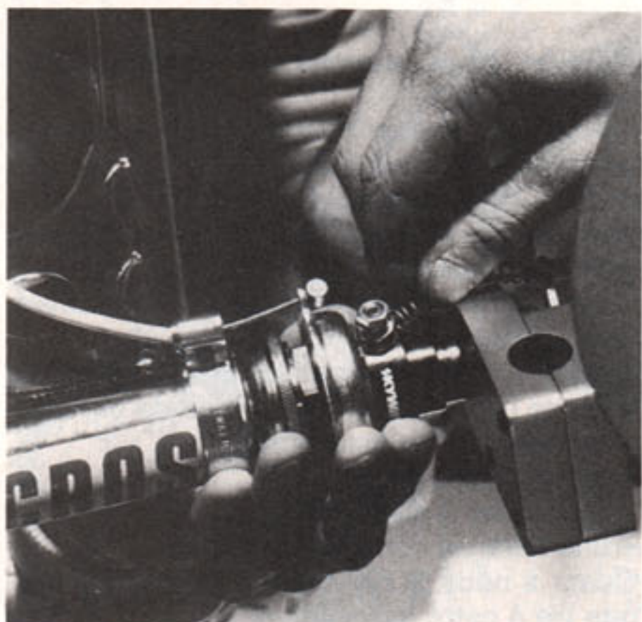
Engagez et fixez le bout du câble supérieur dans son point d'ancrage sur la cuvette du Spin Master. Roulez jeunesse.
