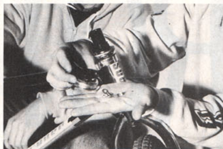
Ouf, le tour est joué. Fixez le pivot en plastique noir (n° 3) sur le jeu de direction. Emparez-vous prestement de la cuvette (n° 4), des boulons, écrous et rondelles (n° 5).
