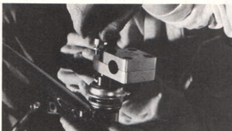
Vissez le boulon percé (n° 7) dans le guide.
