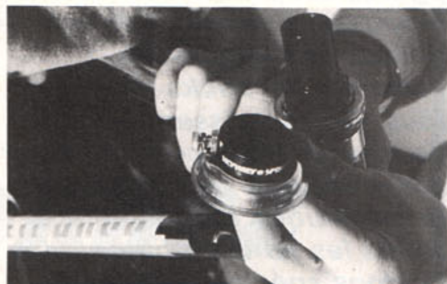
Assemblez ces derniers dans l'unique orifice de la cuvette. Le petit boulon percé va permettre, tout à l'heure, par serrage, de fixer le câble de frein.
