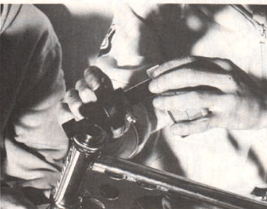
La pièce en graphite (n° 2) se glisse dans la potence.
