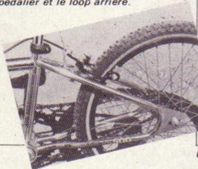
Un gousset de jonction entre le boîtier de pédalier et le loop arrière.
