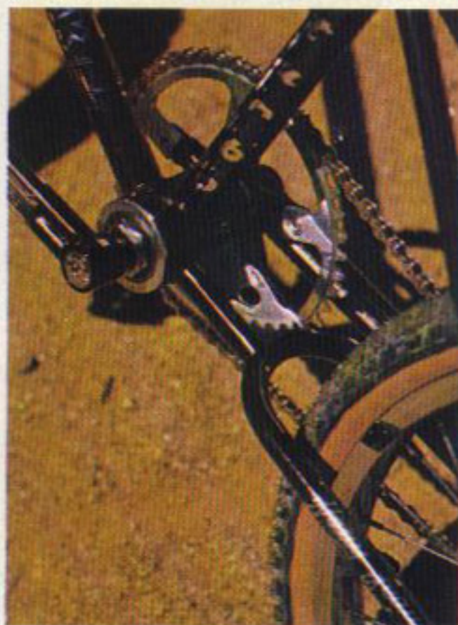
Un gousset de jonction entre le boîtier de pédalier et le loop arrière.
