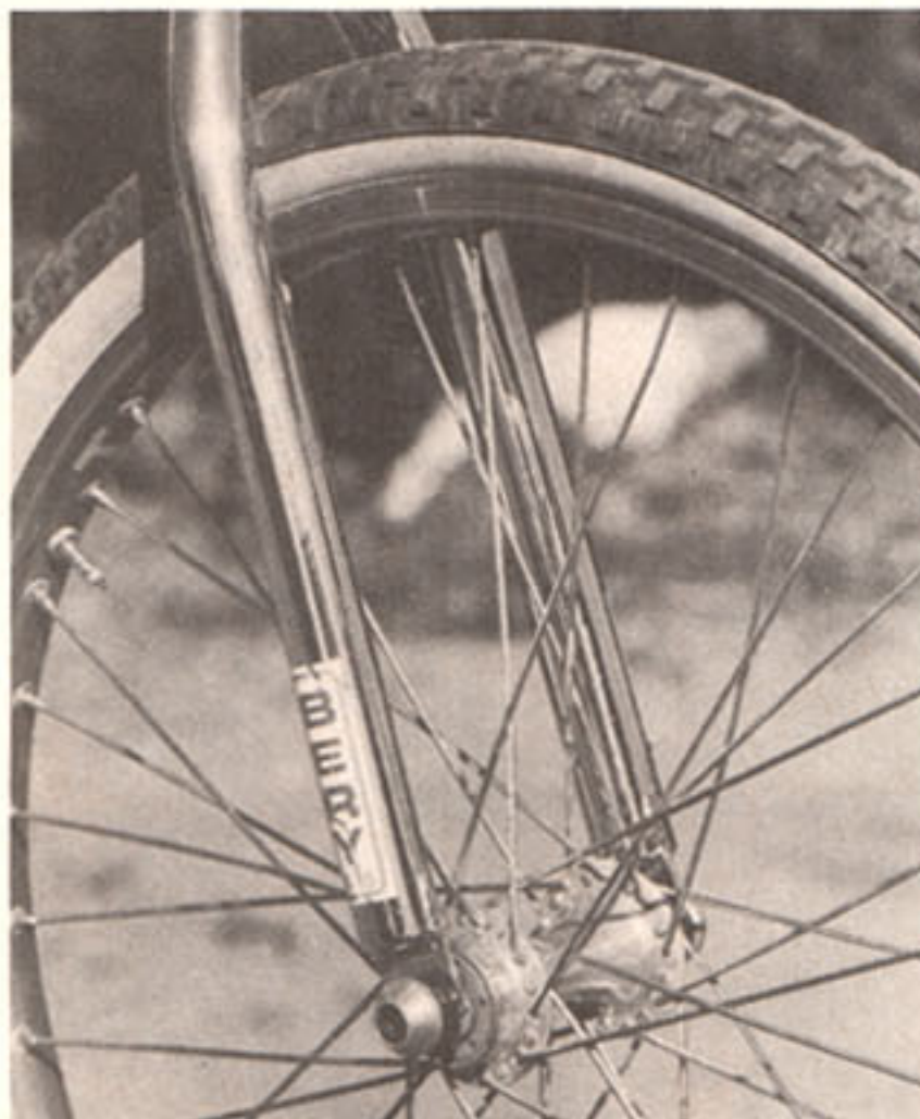
La fourche S15 en acier spécial, fine mais robuste. Moyeux étanches Mavic, jantes Mavic tubulaires à double œillette. Ici monté de pneus Michelin. Les Mavic se marient aussi très bien avec les Wolber.
