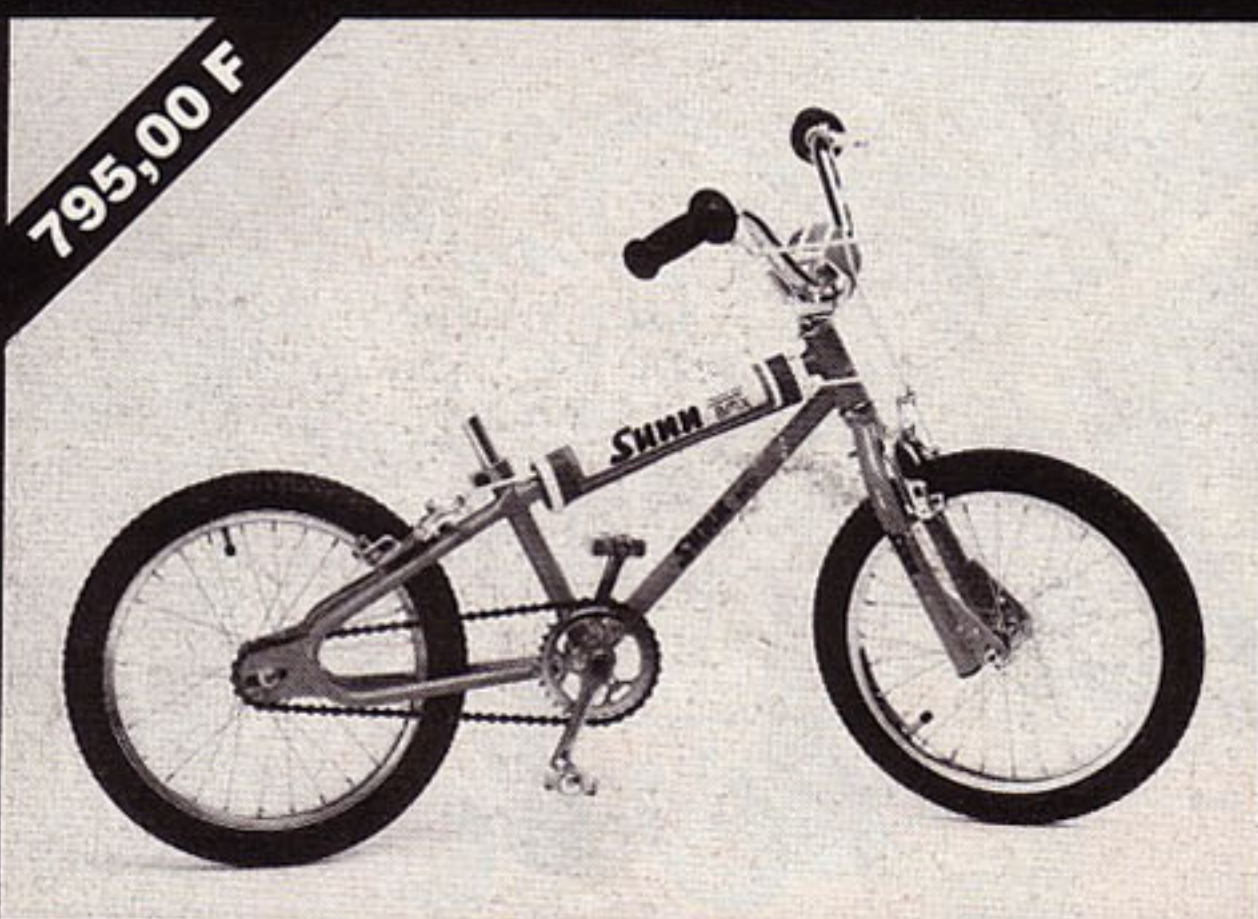
MINI 16 (pour enfants à partir de 2 ans 1/2), Cadre 16 pouces surbaissé, Pédalier 110 x 32, Leviers et freins alu, Pneus Hutchinson cross 16 pouces, Cintre et potence MINI, Selle et tube de selle MINI, GARANTI 5 ANS
