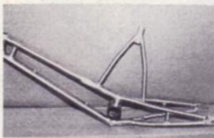
« selle-colonne » et le « boîtier de pédalier-colonne » voient leur diamètre augmenter (celui-ci passe de 28 à 32 mm). Conséquence, en plus d'une meilleure rigidité générale : ils portent mieux sur la colonne de direction et concourent à sa rigidité.
