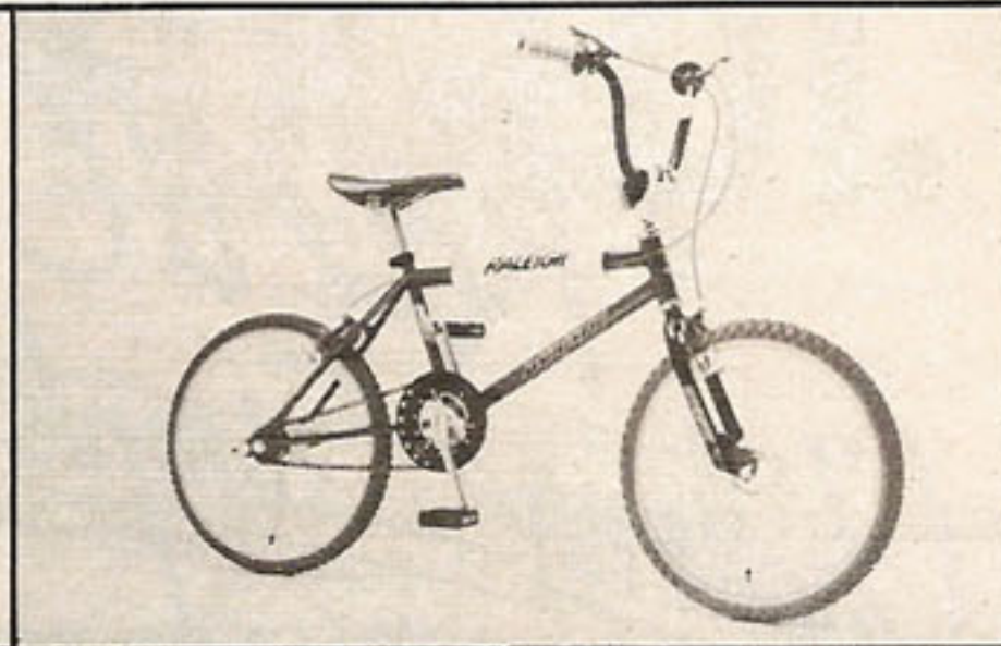
3. Hormis le cadre et la fourche, le Mag Burner est identique à l'ancien modèle. Il est donc équipé de jantes à bâtons Simplex.
