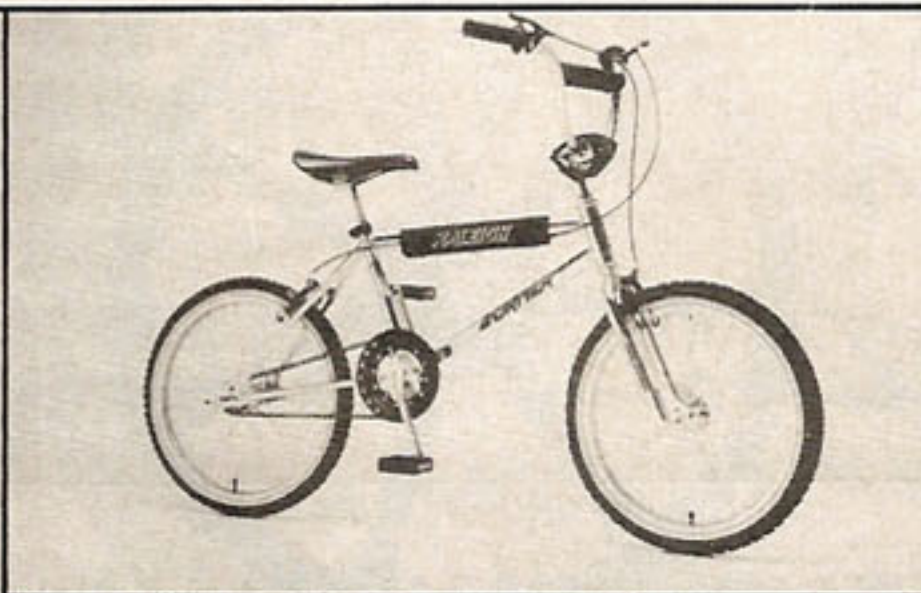
2. L'aéro chrome Burner : trois tubes chrome-moly pour 1399 francs. Visez les poignées Tange. Détail d'ordre esthétique sur tous ces modèles : la présence d'un carter de chaîne. Ce n'est pas très joli mais obligatoire pour l'homologation britannique. Heureusement, ce carter est facilement démontable. Vous y gagnerez en gueule et en poids.
