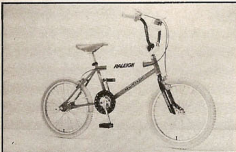
1. L'aéro Burner, ici dans la version rouge. Comme sur les autres modèles, le cadre et la fourche sont nouveaux et profilés. Notez la disparition du gousset de renfort de la direction et le diamètre de la tige de selle : il est standard.
