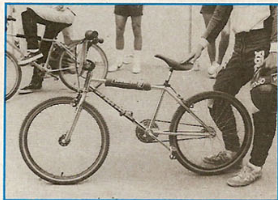
Avec une selle plus confortable et des freins à tirage Cantilever, genre mountain bike, le cruiser 24 pouces est sans doute l'arme absolue en tout-terrain. Ne manquent plus que quelques vitesses, à condition de trouver un mécanisme plus fiable que l'actuel dérailleur !
