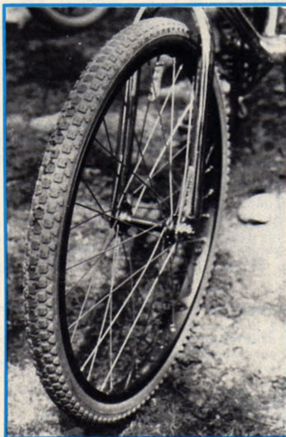
Le Panaracer de National Tyre monté sur une jante Araya de 1.3/8. Ce pneu équipe pratiquement tous les américains, anglais et hollandais.
