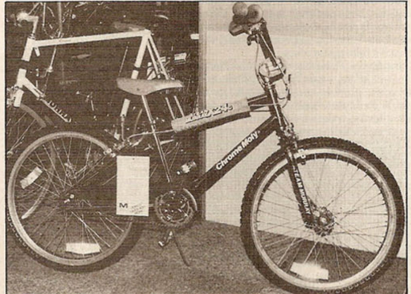
Aux U.S.A. la vogue du « 24 » gagne du terrain. Pour les bicrossers les plus grands, Murray propose son « Team Murray 24 c » dont le cadre au chrome moly re oit des jantes dural de 24 pouces. Le p dalier est un monobloc acier Cr Mo.
