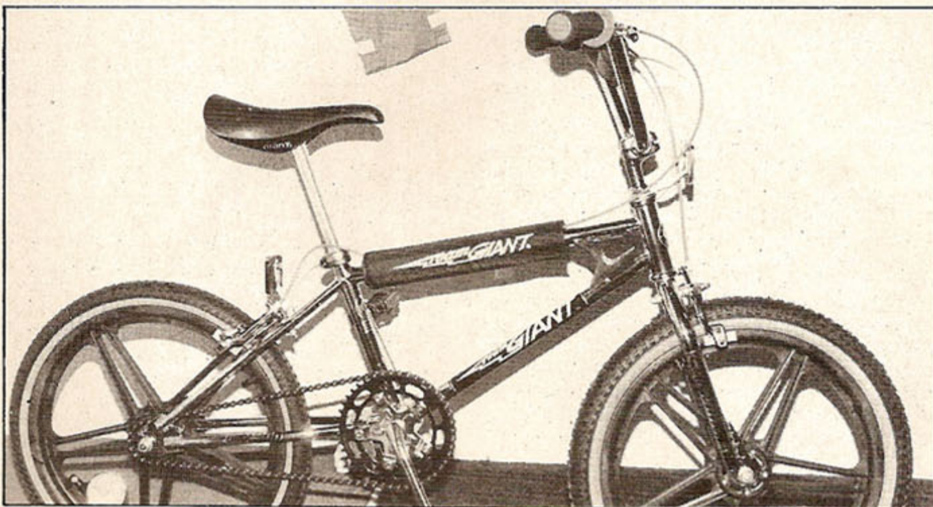
Les meilleures productions taiwanaises n'ont plus à rougir face aux réalisations U.S. ou japonaises. Ainsi le « Team Giant » construit par le principal fabricant de l'île est-il traité avec un soin indéniable. Cadre, pédalier et guidon sont en acier au chrome moly. Les jantes à bâtons sont originales.
