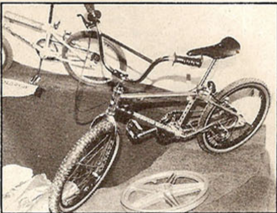
La star du bicross nippon : le Diamond Back. Ligne agressive, esthétique exceptionnelle (chrome et noir), plus des composants hyper sophistiqués et éprouvés, voilà qui produit un vélo de grande classe. Même les pneus sont des Diamond Back, tout comme la potence et la fourche en acier Cr Mo à axe droit. La selle profilée est une Aers.
