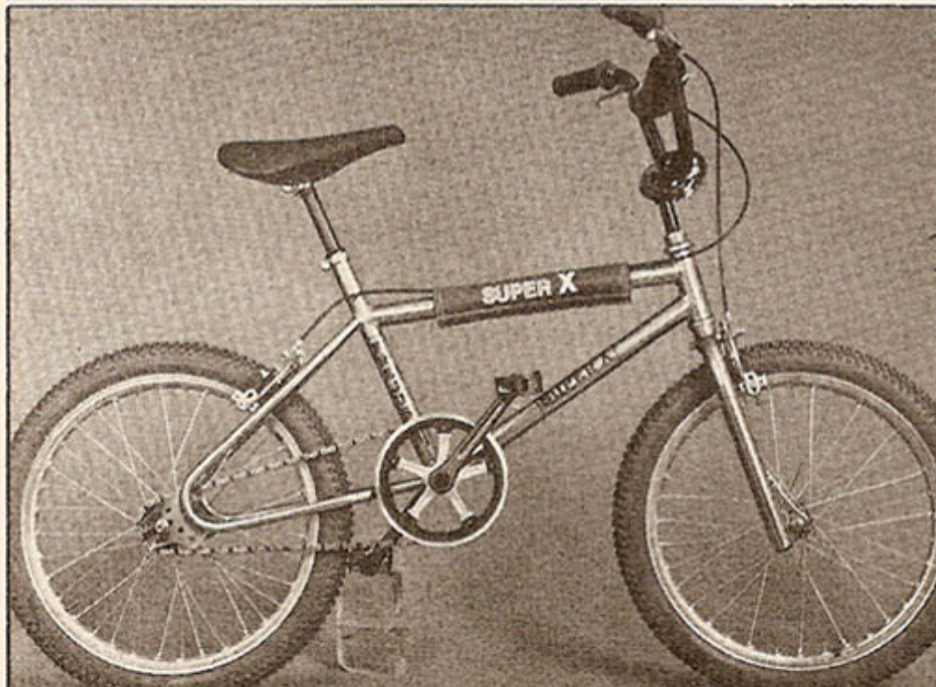
Le nouveau Super X « Professional » de chez Fr jus re oit un nouveau ch ssis au chrome moly, des p dales dural, de nouvelles jantes chauss es de pneus couleur   petits crampons.
