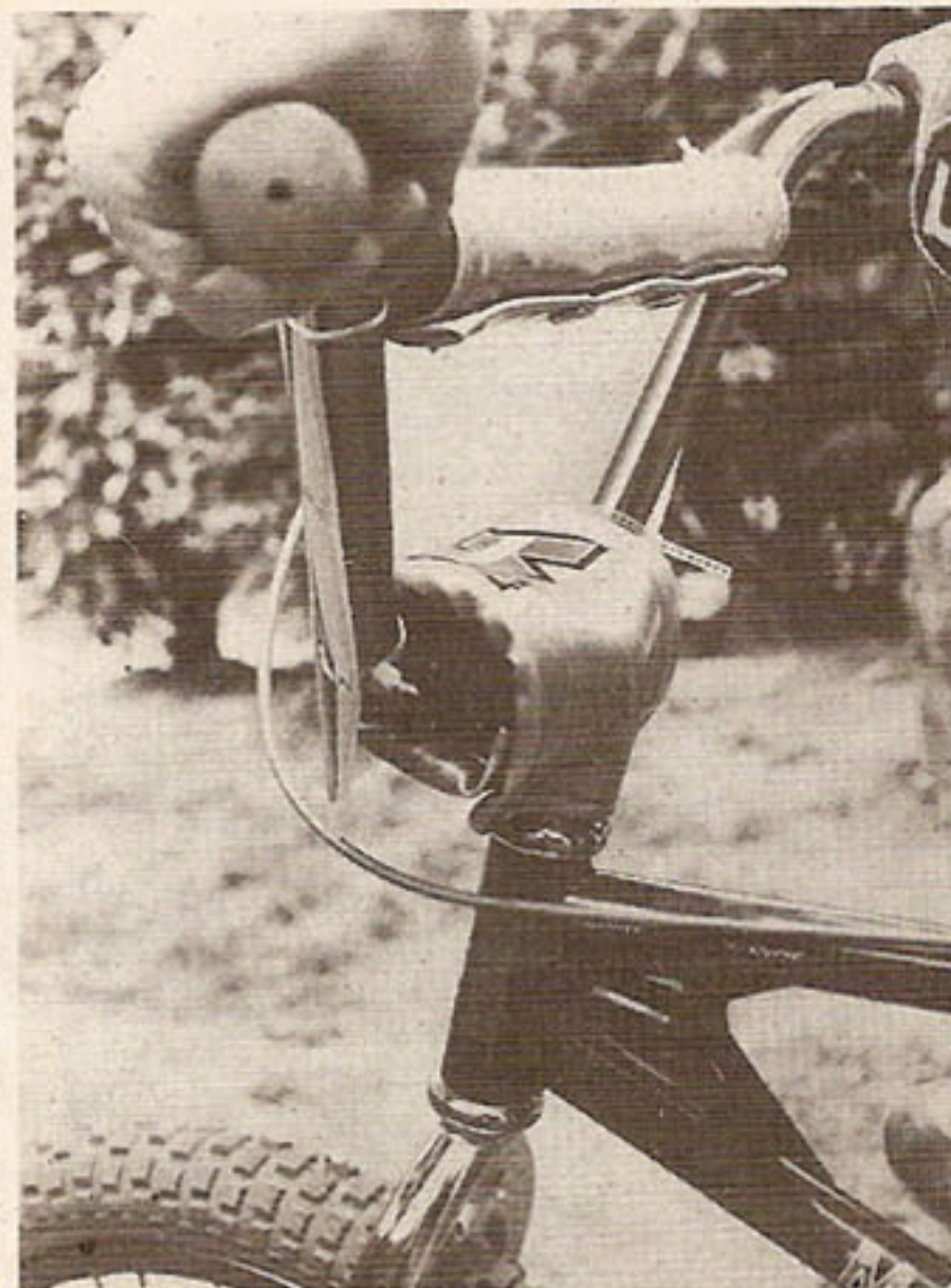
Le guidon est légèrement incliné vers l'avant. En règle commune, l'axe passant par les extrémités du guidon doit se trouver à 2 ou 3 centimètres de l'axe de la potence.
