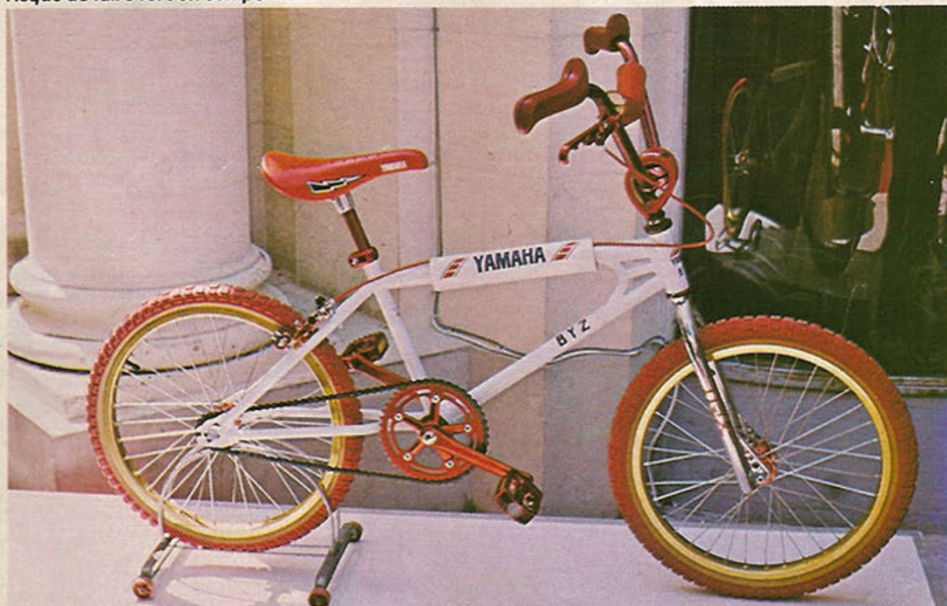
Le BYZ 401 propose plusieurs arguments flatteurs : d'abord un super cachet sportif, mais aussi des jantes dural, une fourche Tange et un ensemble pédalier en alu Mafac bien français.
