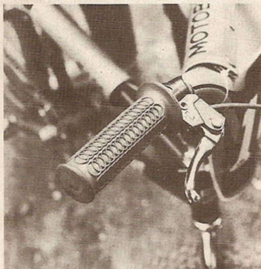
Au guidon on aura intérêt à monter des poignées en caoutchouc assez souple ou en mousse. Les extrémités du guidon seront impérativement bouchées.
