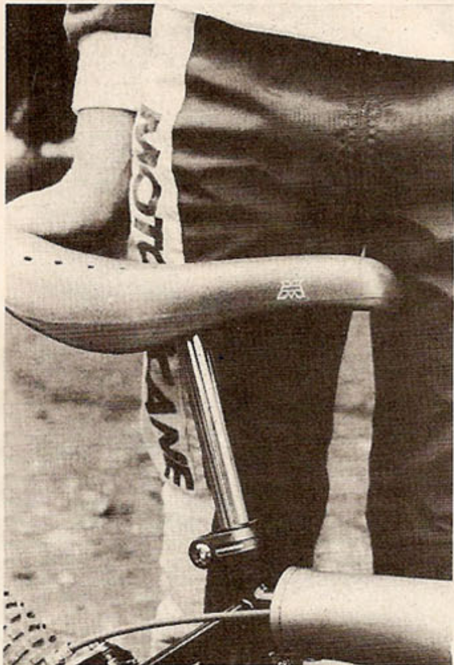
Une selle bien dessinée, en plastique moulé est indispensable. On régler la hauteur de la tige en fonction de la taille du pilote et de sa technique de pilotage.
