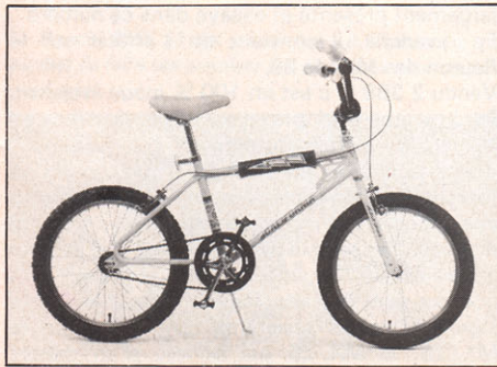
Le BH California s'inspire des productions Yankees. Mais pourquoi diable ce petit boîtier de pédalier et ce pneu avant tourisme alors que l'arrière est cramponné ? C'est l'inverse qu'il faudrait !
